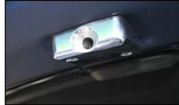
Schieben Sie nun die Spiegelbefestigung über die Spiegelstange und drehen Sie die Rändelmutter bis Gewindeende auf diese.
